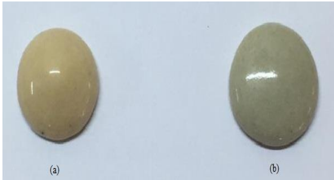
Şekil 2. Albit (a) ve nefelinli siyenite (b) ait bünyelerin 1250 °C’de 30 dk’da pişen görünüşleri.
